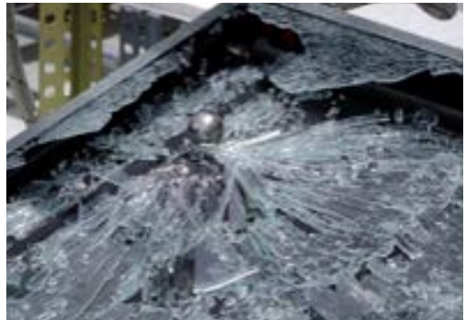
Fig. 1.21. Prueba de impacto con bola de acero.
