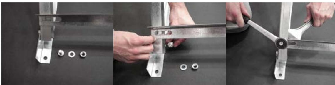
**Ilustración 51. Montaje sobre cubierta plana (7) captadores plano**
