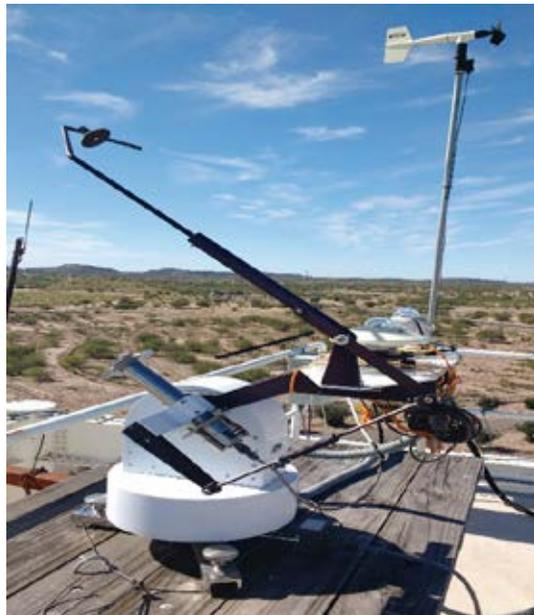
**Ilustración 20. Estación solarimétrica automatizada**
