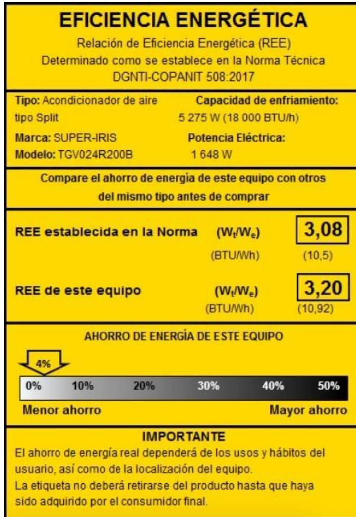
FIGURA 3- Modelo de etiqueta de eficiencia energética en Panamá para Acondicionadores de Aire
