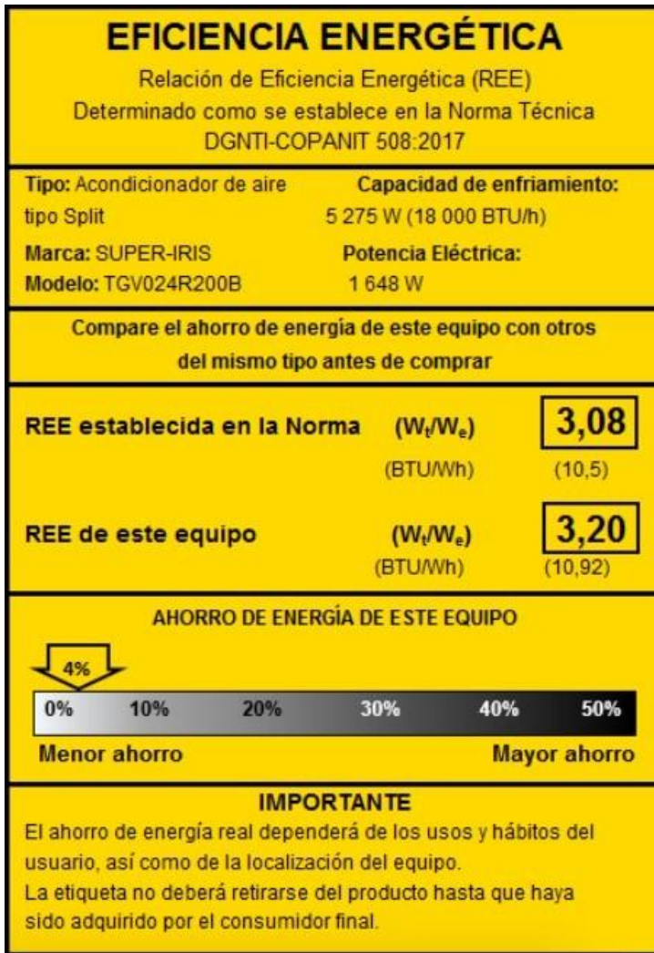
FIGURA 3- Modelo de etiqueta de eficiencia energética en Panamá para Acondicionadores de Aire
